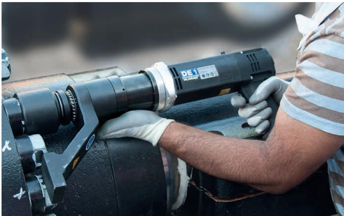
La DE1 a été équipée d'une nouvelle commande qui permet un raccordement vissé plus précis et mieux sécurisé – La tension est surveillée et la vitesse enregistrée. La compensation de fluctuation de tension et de modification de température permet d'atteindre une précision plus élevée du couple de rotation. La DE1 se met automatiquement sur la fréquence de réseaux disponibles (par ex. 50 Hz ou 60 Hz).
